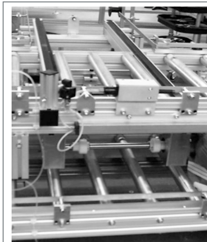
Hub-Quer-Einheit mit Doppelgurtförderer
