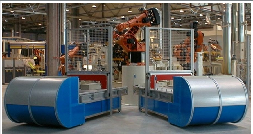
Stauförderer / WT-Transport horizontal Zuführung von Karosserieteilen in eine Schweißzelle
